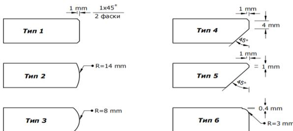
ВАЖНО! Обработка торцов Компакт-плит по ТИП'ам 1-6 со всех 4х сторон возможна на деталях размером не менее 100мм!!!
